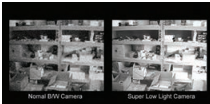
شکل ۱۸- تأثیر مشخصه Minimum Illumination در تصویر
