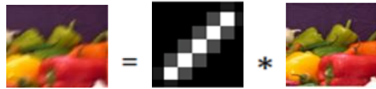
شکل 1. تصویر تار حاصل شده از کانولوشن تصویر واضح با هسته تار (Yadav et al, 2016)
