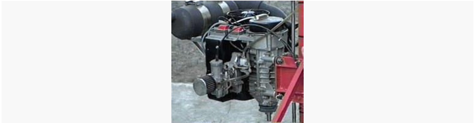
کاوازاکی مدل ۳۴۰، قدرت: ۳۰ اسب بخار، وزن: حدود ۳۰ کیلوگرم، هواخنک
