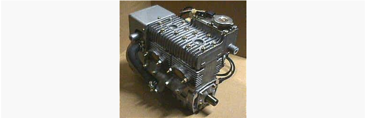
فوجی مدل ۳۴۰، قدرت: ۴۰ اسب بخار، وزن: ۴۰ کیلوگرم، دو کاربورات، گیربکس سرخود
