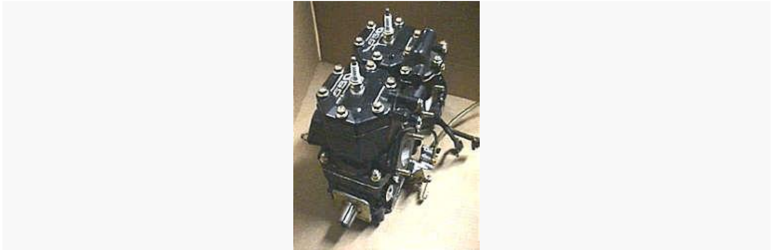
سوزوکی مدل ۵۵۰، قدرت: ۹۰ اسب بخار، وزن: ۳۳ کیلو، سیستم خنک کننده: روغن
