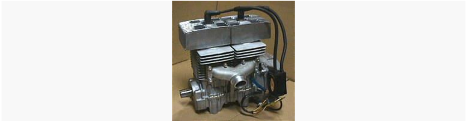
کاوازاکی مدل ۳۴۰، قدرت: ۳۰ اسب بخار، وزن: حدود ۳۰ کیلوگرم، هواخنک
