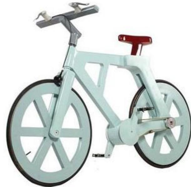
همه چیز این فناوری بجز زنجیر و ترمزها از مقوا ساخته شده‌اند. این کاغذها با ماده ضد آب رزین پوشش یافته و سپس چاپ شده‌اند. این دوچرخه می‌تواند به عنوان یک وسیله حمل و نقل ارزان در مناطق روستایی جهان سوم و همچنین یک خودروی کاملاً دوستدار طبیعت مورد استفاده قرار بگیرد.
