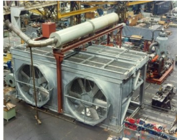
(شکل شماره: ۲-۲-۱۰) از راست به چپ Air cooled Coolers و طریقه کارکرد Air Cooled
