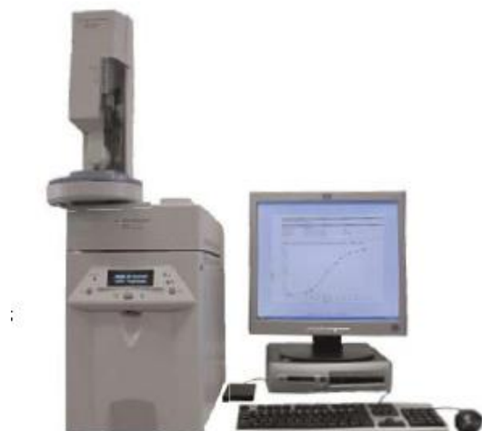
دستگاه استاندارد تقطیر ASTM D-2887
