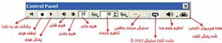
شکل ۲-۲۱: تابلوی کنترل (Control Panel)
