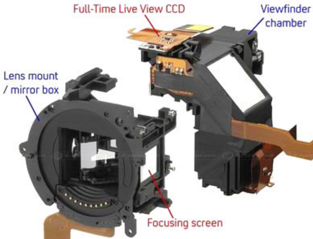
جعبه آینه و قطعات سیستم Live MOS Sensor
