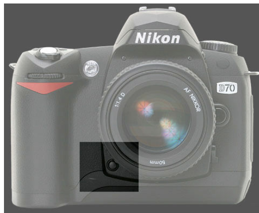
تصویر 1) محل دکمه پیش نمایش عمق میدان بروی نیکون D70
