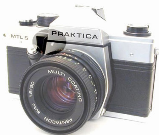
تصویر 2) محل دکمه پیش نمایش عمق میدان و دکمه نورسنج بروی Praktica MTL5
