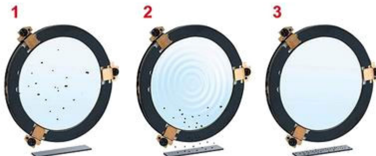
نحوه عملکرد سیستم Supersonic Wave Filter
