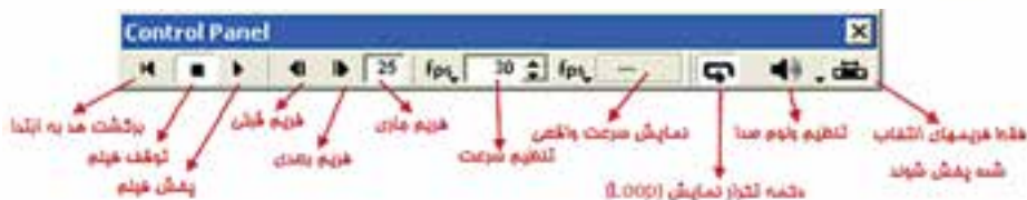
شکل ۲-۲۱: تابلوی کنترل (Control Panel)
