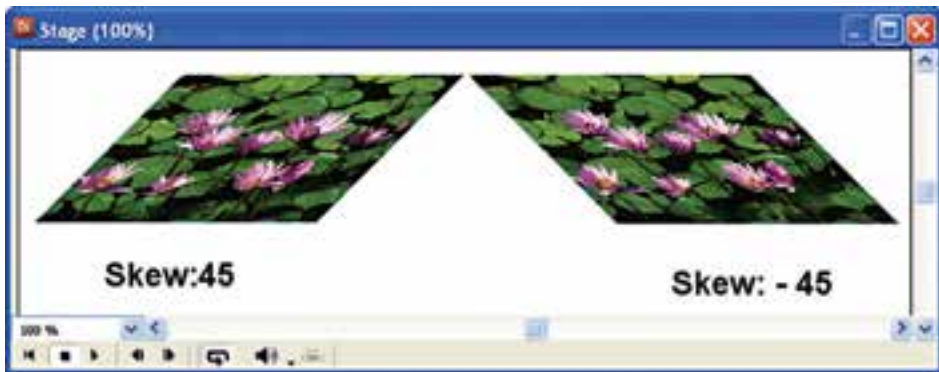
شکل ۱۳- ۵ مایل کردن اسبیرایت در جهت عقربه‌های ساعت و در خلاف آن به اندازه ۴۵ درجه
