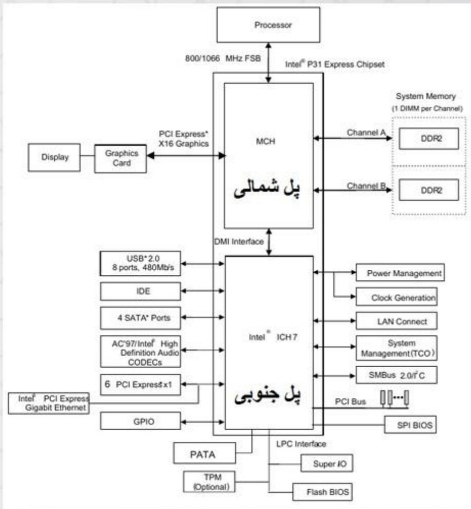
مادربرد های به روزتر شیوه برقراری ارتباط بین اجزای آن متفاوت می باشد مثلا Ram DDR۳ به طور مستقیم با cpu در ارتباط می باشد اما Ram DDR۲ ابتدا به پل شمالی متصل می شود و پی شمالی ارتباط آن را با پردازنده ممکن می سازد. روال کار لپ تاپ به خاطر داشتن برخی خصوصیات کمی متفاوت تر عمل می کند. که در آینده به ان می پردازیم.
