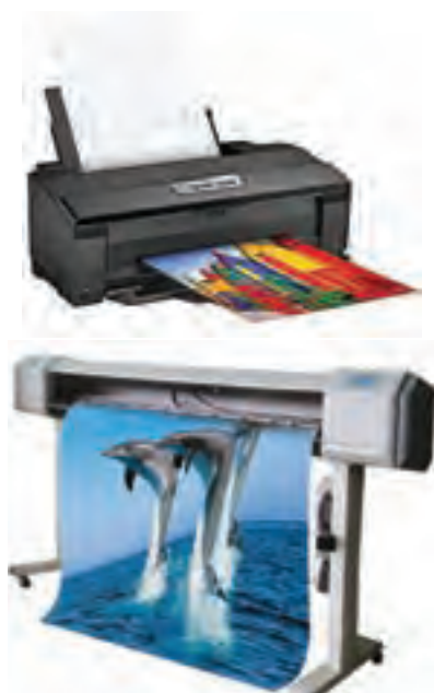
تصویر ۸۶ ▲ کاغذ شیت در چاپگر عکس (تصویر بالا) کاغذ رول در چاپگر عکس (تصویر پایین)
