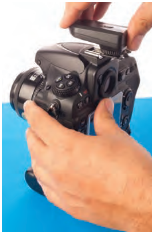
▲ اتصال ریموت فرستنده به دوربین | تصویر ۱۳۵
