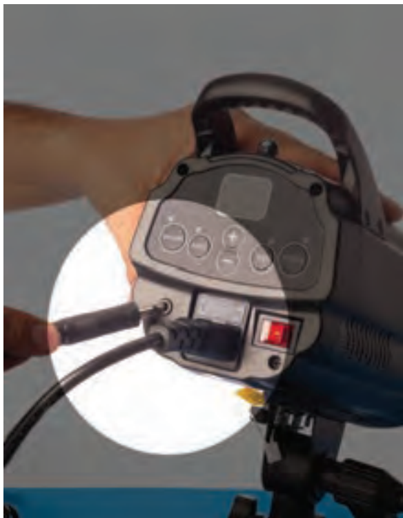
▲ اتصال سیم سینکرون رادیوتریگر به فلاش | تصویر ۱۳۶
